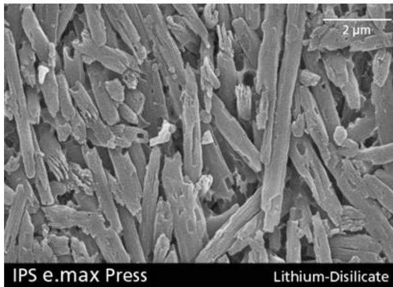
Fig. 3: struttura di IPS e.max Press (SEM, mordenzato in vapore di HF per 30 sec.)
