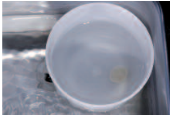
Rimuovere i residui con bagno ad ultrasuoni...
