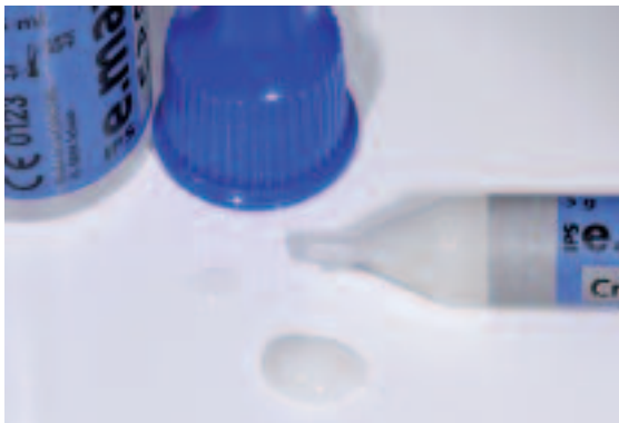
Prelevare IPS e.max CAD Crystall./Glaze Paste dalla siringa e miscelare. Se necessario, diluire leggermente con IPS e.max CAD Crystall./Glaze Liquid.
