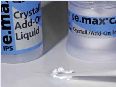
Anmischen des IPS e.max CAD Crystall./Add-On mit IPS e.max CAD Crystall./Add-On Liquid zu einer modellierfähigen Konsistenz
