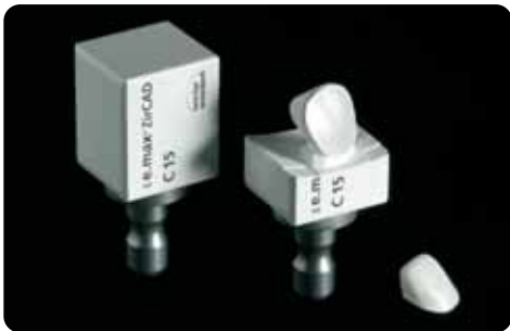
La lavorazione del blocco IPS e.max ZirCAD avviene allo stato parzialmente sinterizzato "tipo gessetto" nel sistema inLab della Sirona. Il manufatto fresato viene quindi sinterizzato nel forno ad alta temperatura Sintramat.
