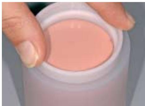
Riempire il cilindro fino alla demarcazione ed applicare il calibro del cilindro con un movimento d'inclinazione.
