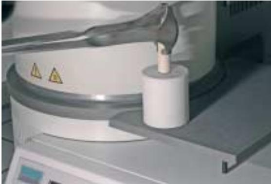
Quindi inserire nel cilindro **caldo** il pistone in allumina IPS e.max umettato con la polvere.
