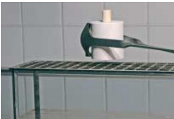
Terminato il programma di pressatura, posizionare il cilindro caldo mediante la pinza per cilindro sulla griglia di raffreddamento e lasciar raffreddare fino a temperatura d'ambiente.
