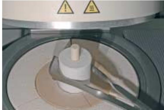
Posizionare mediante la pinza per cilindri il cilindro **caldo** e completato al centro del forno di pressatura **caldo**.
