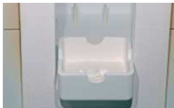
Posizionare cautamente il contenitore di sinterizzazione nel Sintramat.
