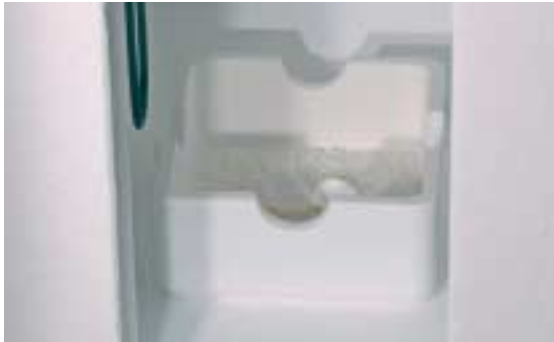
Posizionare il contenitore di sinterizzazione fino a toccare i perni di delimitazione
