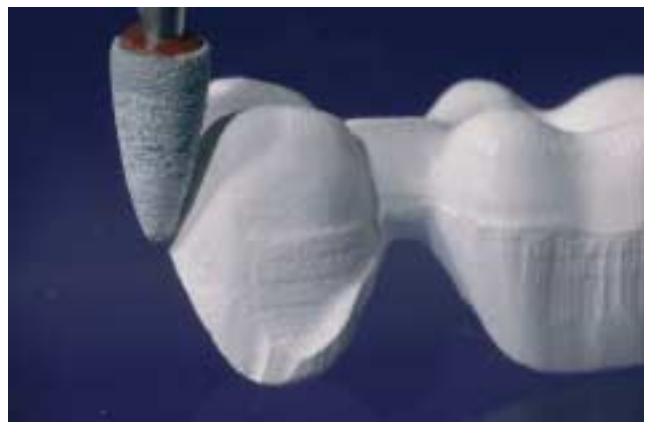
Rifinire la struttura non sinterizzata mediante adeguati strumenti per rifinitura.
