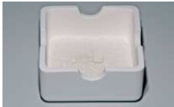
Ultimato il processo di sinterizzazione lasciar raffreddare il contenitore di sinterizzazione a temperatura d'ambiente e prelevare dal Sintramat.
