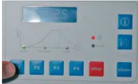
Premere il tasto P1 ed il programma di sinterizzazione si avvia automaticamente, bloccando lo sportello del forno.
