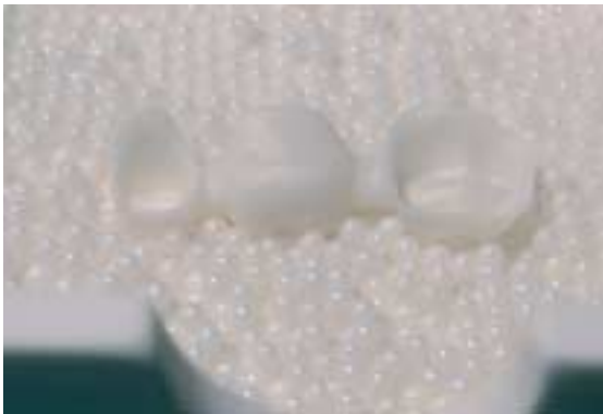
Ideale supporto del restauro sinterizzato dopo il processo di sinterizzazione.
