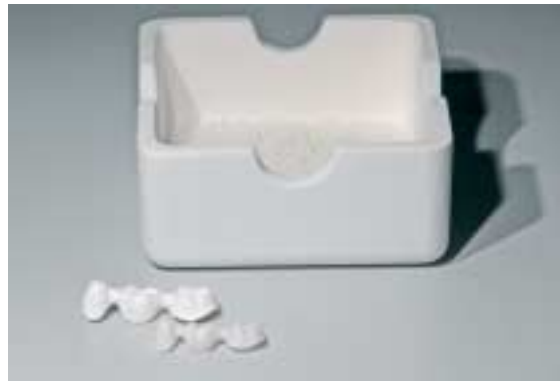
Confronto di struttura IPS e.max ZirCAD non sinterizzata e sinterizzata.
