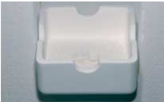
Ultimato il processo di sinterizzazione lasciar raffreddare il contenitore di sinterizzazione a temperatura d'ambiente e prelevare dal Sintramat.
