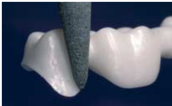
Eseguire la rettifica con turbina a raffreddamento ad acqua oppure con strumenti di rifinitura per ZrO 2 espressamente sviluppati.
