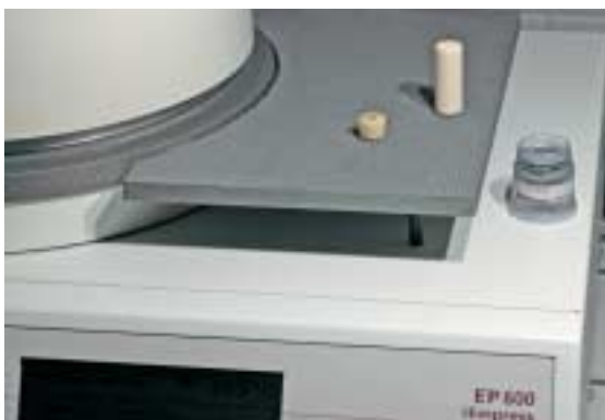
Preparare a portata di mano il pistone in allumina IPS e.max freddo ed il grezzo IPS e.max freddo nel colore desiderato.
