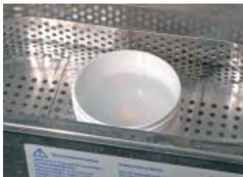
Rimuovere accuratamente lo strato reattivo formatosi con Al_2O_3 e 1–2 bar di pressione.
