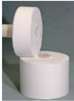
Separare il cilindro con un disco separatore e rompere lungo la zona predisposta alla rottura.
