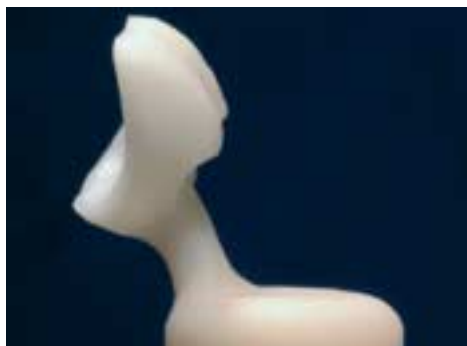
Rimuovere accuratamente lo strato di reazione formatosi con Invex e con Al_2O_3 a 1–2 bar di pressione.
