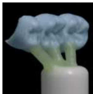
L'imperniatura avviene sulla base per cilindro IPS e.max sempre in direzione del flusso e nel punto più spesso.
