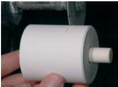
Separare il cilindro con un disco separatore e rompere lungo la zona predisposta alla rottura.
