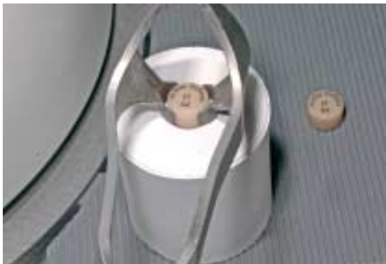
Posizionare i grezzi IPS e.max ZirPress freddo con il colore del grezzo nel cilindro caldo verso l'alto.
