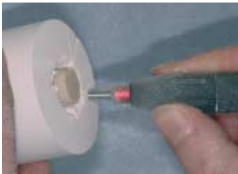
La smuffolatura grossolana avviene con sabbia per lucidatura a 4 bar di pressione finché gli oggetti diventano visibili. La smuffolatura fine avviene a 2 bar di pressione.
