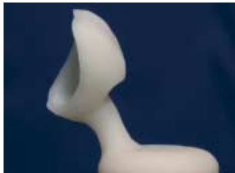
La smuffolatura grossolana avviene con sabbia per lucidatura a 4 bar di pressione finché gli oggetti diventano visibili. La smuffolatura fine avviene a 2 bar di pressione.
