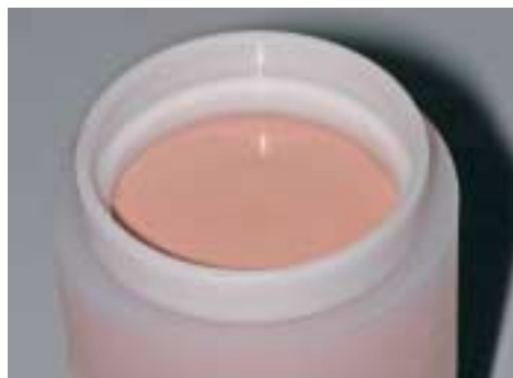
Riempire il cilindro fino alla demarcazione ed applicare lo squadracilindri con un movimento d'inclinazione.
