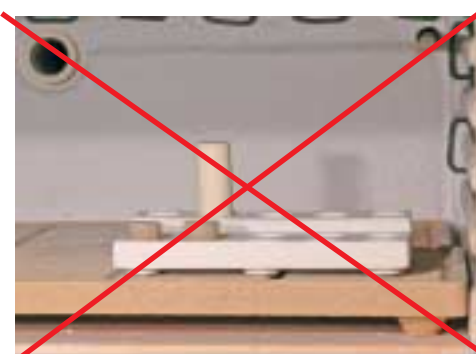
Non preriscaldare i grezzi ZirPress ed i pistoni in allumina.
