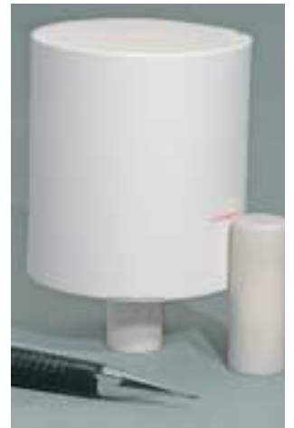
Demarcare la lunghezza del pistone in allumina
