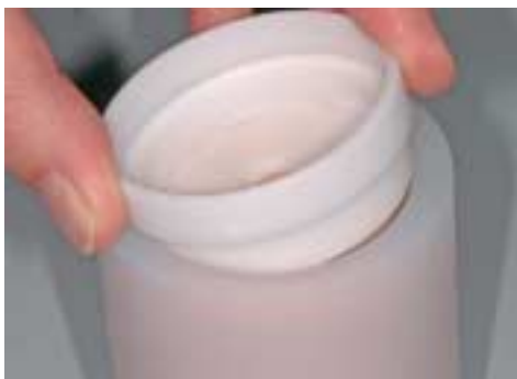
Riempire il cilindro fino alla demarcazione ed applicare lo squadracilindri con un movimento d'inclinazione.
