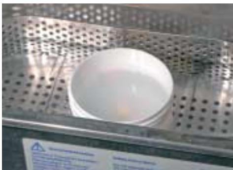
Rimuovere accuratamente lo strato di reazione formatosi con Invex e con Al_2O_3 a 1–2 bar di pressione.
