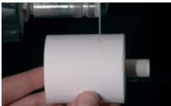
Separare il cilindro con un disco separatore e rompere nella zona predisposta alla rottura
