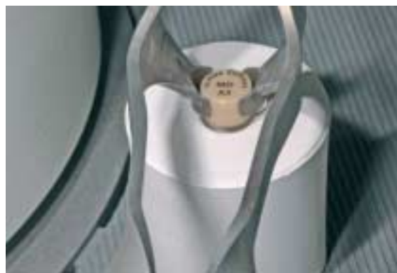
Posizionare il grezzo IPS e.max ZirPress freddo con il colore del grezzo nel cilindro caldo verso l'alto.
