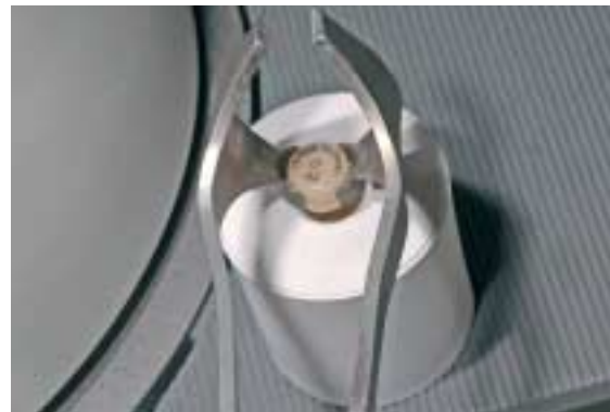
Posizionare i grezzi IPS e.max ZirPress freddo con il colore del grezzo nel cilindro caldo verso l'alto.
