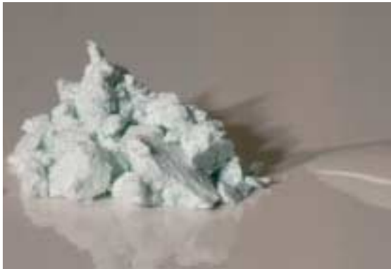
Miscelare il relativo ZirLiner con liquido ZirLiner in consistenza setosa ed applicarlo in strato coprente sulla struttura.
