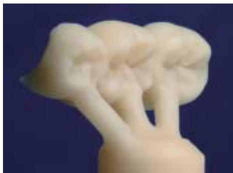
Rimuovere accuratamente lo strato reattivo formatosi con Al_2O_3 e 1–2 bar di pressione.
