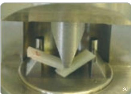
Fig. 3: test di flessione a tre punti con campioni metallici e ceramici:
