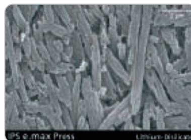
Fig. 1: nell'IPS e.max Press la matrice vetrosa è riempita con ca. il 70% di cristalli di disilicato di litio. Si ottiene un'elevata resistenza, in seguito all'intreccio di cristalli aghiformi. Per l'immagine al SEM la matrice vetrosa è stata mordenzata.
