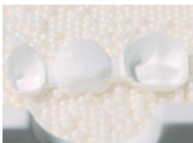
**Fig. 12:** struttura di ponte a 3 elementi in IPS e.max ZirCAD su sfere in ZrO<sub>2</sub> dopo il processo di sinterizzazione
