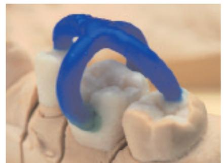
**Fig. 18:** applicazione dei canali di alimentazione (da osservare il canale ad anello sull'elemento intermedio)
