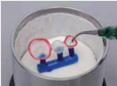
Mettere in rivestimento il modello di fusione in conformità alle istruzioni del produttore del rivestimento e sistemare nel forno di preriscaldamento.
