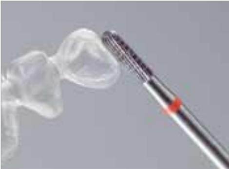
I bordi marginali fresati in spessore maggiorato vanno ridotti con una fresa in metallo duro a taglio incrociato fine (anello rosso). In caso di elementi completamente anatomici occorre controllare l'occlusione.
