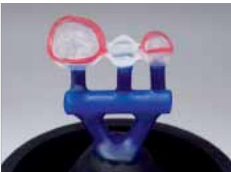
Come noto dalla tecnica di fusione o dalla tecnica di pressatura, dotare il modello di fusione di perni di colata in cera e fissarlo sul cono di colata. Attenersi alle istruzioni del produttore della lega o della presso-ceramica.
