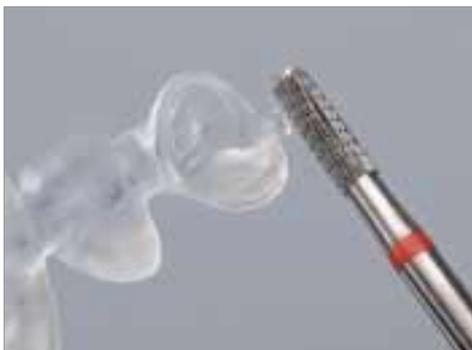
Dopo il processo di fresaggio (CAM) eliminare il perno con una fresa in metallo duro a taglio incrociato fine (anello rosso).
