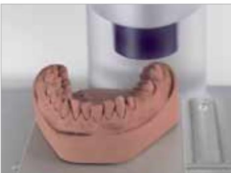
Posizionare il modello in gesso scansionabile sul piano di scansione dell'apparecchiatura inEos ed eseguire la scansione.\*
