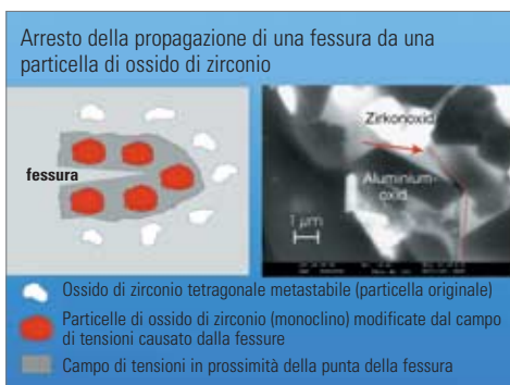
Fig. 1: Principio del rafforzamento da conversione (fig. a sinistra) e ripresa SEM di una fessura (di fianco alla linea rossa), che attraversa il vetro infiltrato nella struttura e viene arrestata (punta della freccia) da una particella di ossido di zirconio (bianco)
