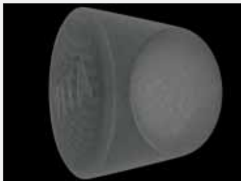
Fig. 2: Ripresa tomografica computerizzata (prospettiva) di un pellet VITAPM9. La struttura della ceramica è assolutamente priva di imperfezioni.
